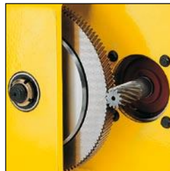
Caixa de engrenagens con embraiagem de deslizamento
